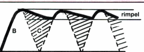
kggerichte wisselspanning. De condensator ase C. De condensator moet dus groot genoeg e kunnen leveren. Tijdens de stroomleverantie tgangsspanning verandert. Die spannings-
